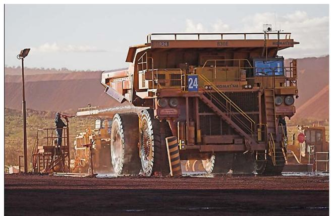
Los modernos equipos de limpieza operan con agua a vapor y presiones superiores a los 140 kg/cm<sup>2</sup> a
