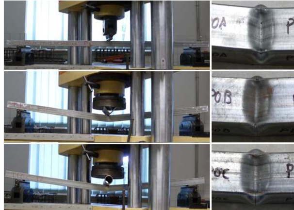
Figura 1: Ensayos con distintos dispositivos de apoyo
