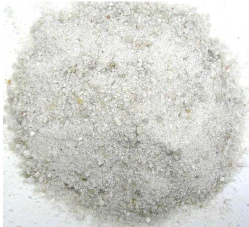
Fotografía 7: Arena clasificada y lavada
