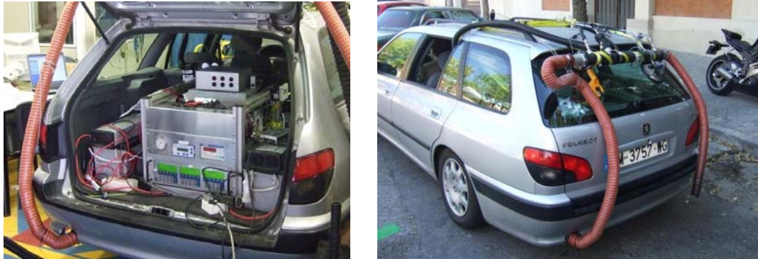
Figura 2- Sistema de medida de emisiones contaminantes – MIVECO-PEMS
