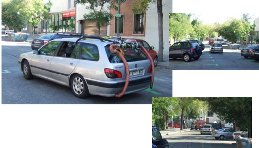
Figura 12- Pruebas en tráfico real del equipo MIVECO-PEMS.
