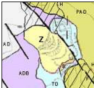
Figura Nº 2. Mapa geológico del yacimiento San José-Los Escullos. (Z) Zeolita; (TD) Tobas dacíticas; (AD) Andesitas piroxénicas; (PAD) Piroclastos y flujos de andesita; (B) Bentonita; (ADB) andesita brechosa; (H) Alteración hidrotermal intensa; (F) Fallas.
