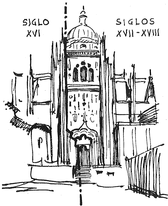
Catedral Nueva de Salamanca. Línea donde se interrumpió la obra en el siglo XVI por los hastiales norte y mediodía.
