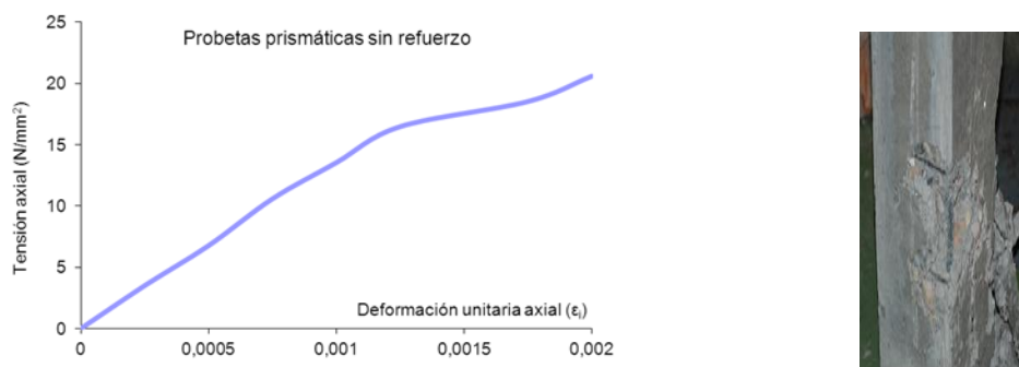
Figura nº 6. Gráfica tensión-deformación de probetas prismáticas sin refuerzo.
