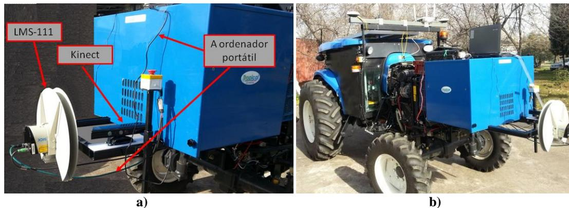
Figura 1. a) Montaje de la cámara RGB-D y LIDAR en el frontal del tractor. b) vista completa del tractor.
