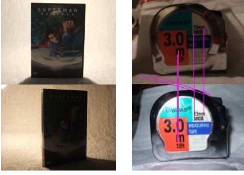
Figura 4: Resultados obtenidos con el sift original en escala de grises. En la imagen izquierda no se ha logrado ningún match y en la derecha pocos matches points.
