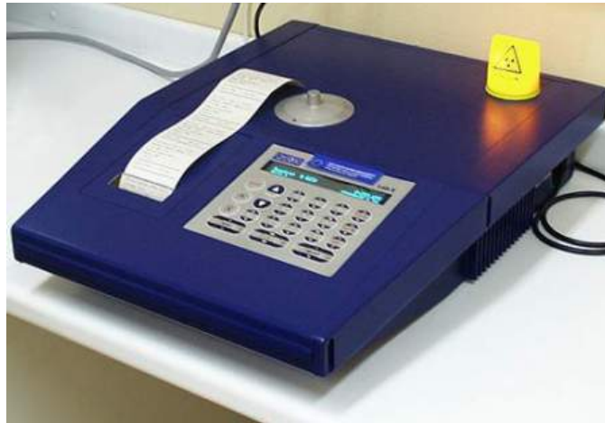
Figura 2. Equipo de determinación del contenido de azufre (EN ISO 8754)
