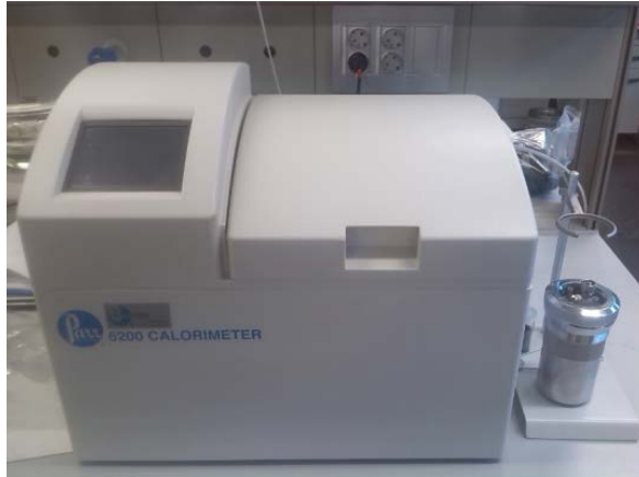
Figura 7. Equipo para la medición del poder calorífico. (ASTM D 240)
