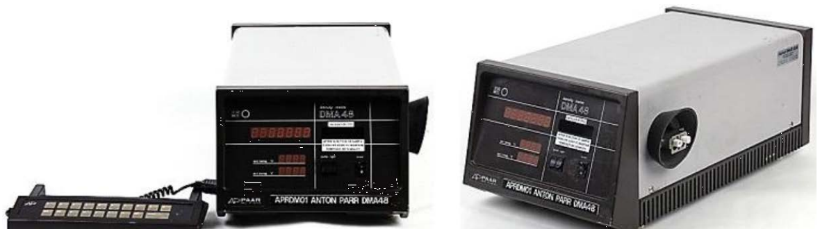
Figura 6. Densímetro digital DMA 48 (Anton Para GmbH ASTM D 1298)
