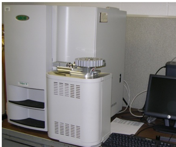
Figura 8. Análisis elemental LECO (ASTM D 5291)
