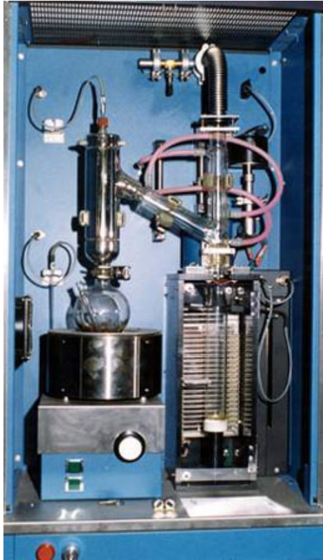
Figura 4. Equipo de Destilación a vacío (ASTM D 1160)
