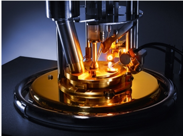
Figura 3. Punto de inflamación (ASTM D 93)
