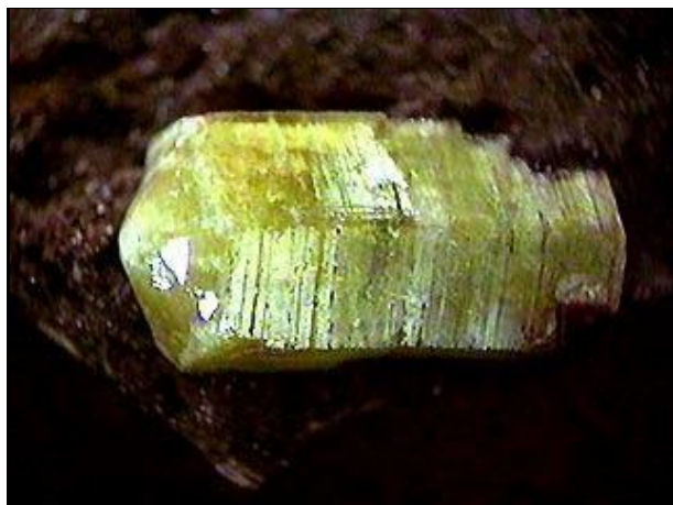
Fig. 3 Monocristal de etringita Fuente: Santiago Buey, C. Estudio a escala microscópica de los fenómenos de interacción suelo-cal, 2000.
