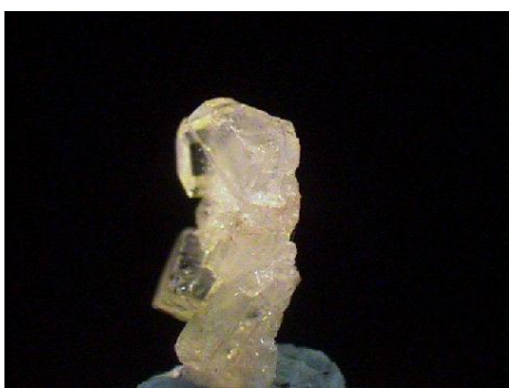
Fig. 7 Monocristal de taumasita. Fuente: Santiago Buey, C. Estudio a escala microscópica de los fenómenos de interacción suelo-cal, 2000.
