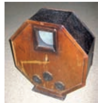
Figura 23. Receptor de televisión, modelo octagon, construido por la General Electric en 1928. Era un receptor de 48 líneas, con una pantalla de 3 pulgadas, que la General Electric diseñó pensando en su fabricación en serie. Esta decisión fue desechada, finalmente, pues la falta de perfeccionamiento que aún demostraba la televisión mecánica, unido a la latente timidez del mercado por el nuevo medio, aconsejaron mantener la prudencia. Fuente: http://www.earlytelevision.org/ .
