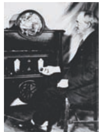
Figura 16. Jenkins sentado ante un radiovisor de su invención. La pantalla no es tan grande como aparenta en la fotografía. Realmente, se trata de un cristal, en forma de lupa, que aumenta la imagen real que reproduce el mecanismo de barrido óptico localizado en su interior. De nuevo, el receptor de sonido se encuentra ubicado en la parte inferior del mueble. Fuente: Baird Laboratory Glass Lecture Slides, Baird-1930.
