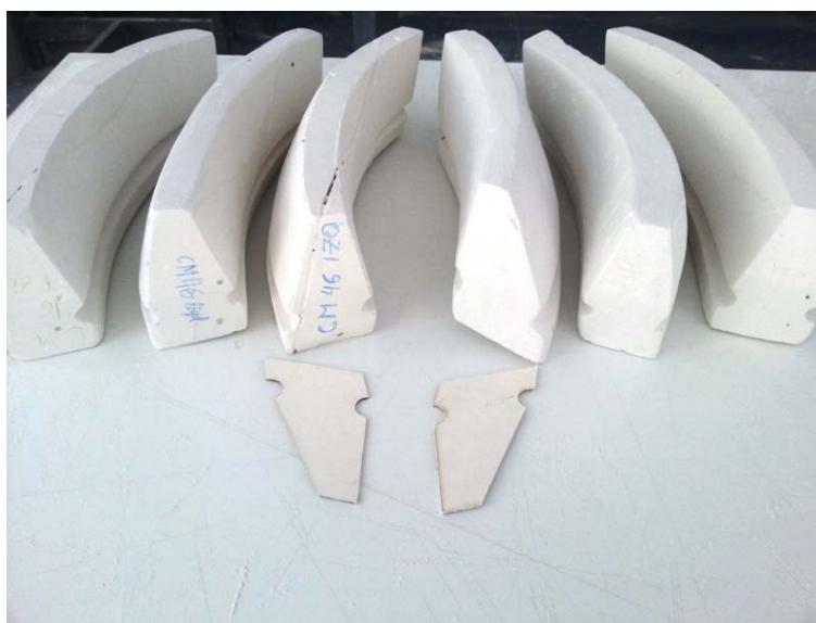
Figura 7. Nervios combados en proceso de talla con sus plantillas, con y sin reviro. Las simetrías y sus reviros a izquierda o derecha añaden insospechadas dificultades a la labra de estas piezas (imagen autores).
