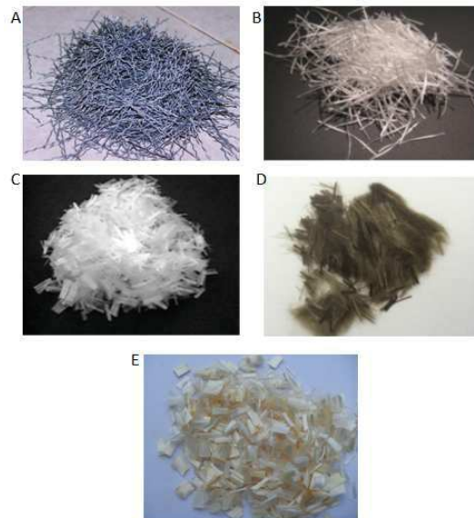
Fig. 1: Tipos de fibras. A) Acero. B) Polipropileno. C) Vidrio. D) Basalto. E) Acrílicas
