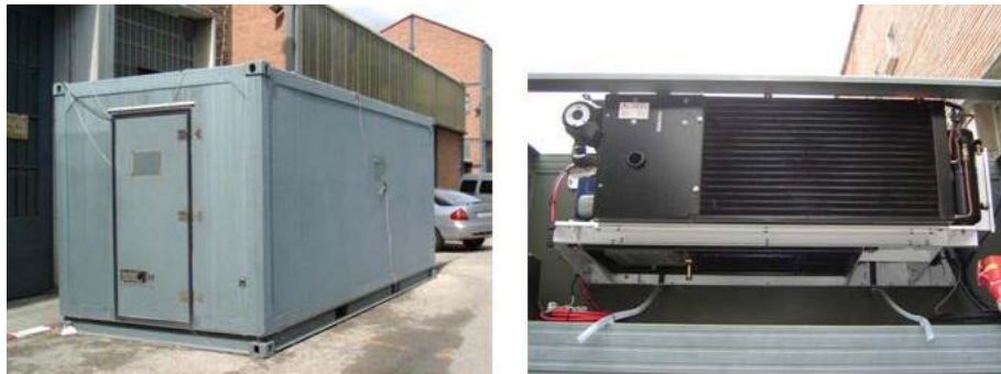
Fig. 1: (Izq.) Contenedor de transporte internacional. (Der.) Equipo de refrigeración. Fuente: LPFTRAG-UPM
