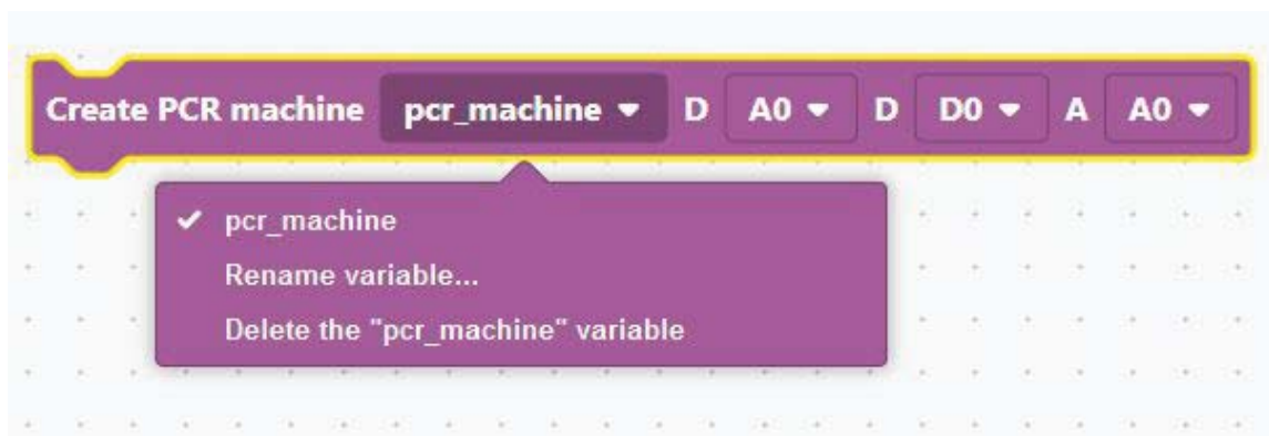
Figura 10. Primer prototipo de un bloque de creación de hardware una PCR
