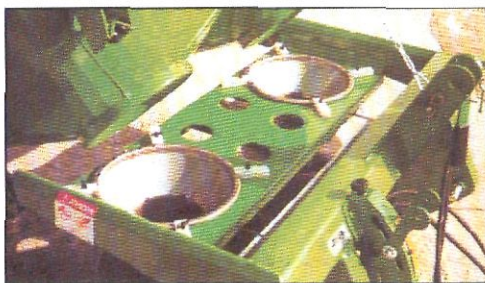
La tolva basculante permite realizar la limpieza del sistema de distribución de manera más fácil, de Gil.
