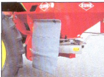
Detalle de la placa lateral para realización de abonado cerca de linderos (Kuhn).
