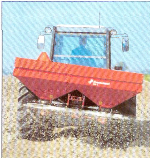
Abonadora unilateral con el cilindro hidráulico de inclinación de Kvermeland.
