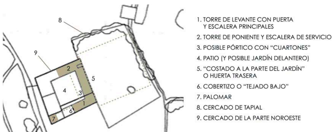
Fig. 203. Casa de la Vega en Gamonal. Localización hipotética de los diferentes componentes identificados en el reconocimiento de 1671, señalados sobre la planimetría del Plan Parcial de 2001 (elaboración propia, 2021).
