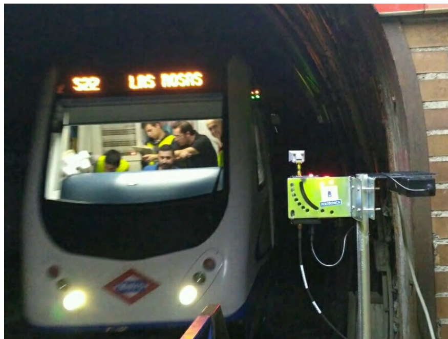
(b) Escenario de medición: Posición fija de Tx al principio del túnel y Rx en movimiento en el parabrisas del tren
