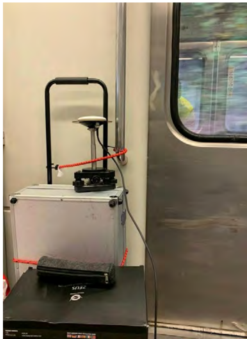
Figura 7.6: Instalación de antena interior para realización de medidas GPS
