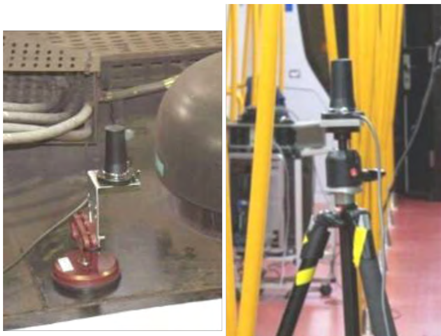
(b) Posición de las antenas Exterior-interior.
