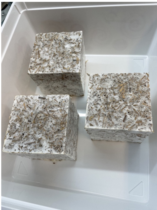
Fig. 19. Ladrillos coproducidos con el crecimiento de Micelio. Imagen de Myceen.
