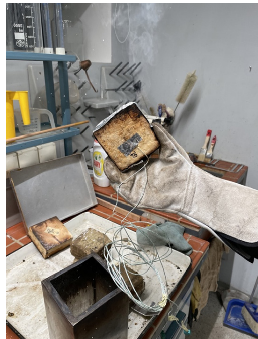
Fig. 20. Pruebas de resistencia al fuego de bloques de micelio en la Universidad Tecnológica de Tallin.
