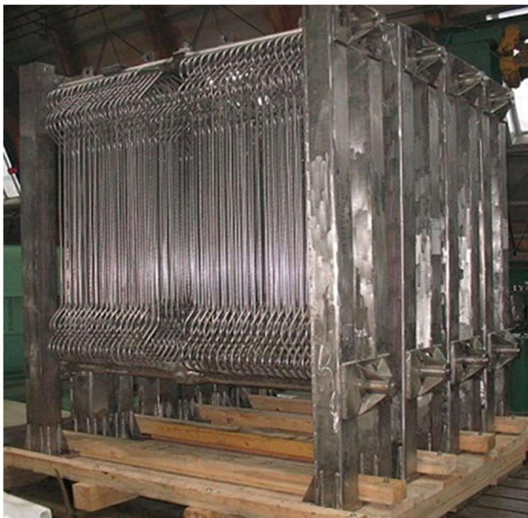
Figure 2-51 PHRS heat exchanger imagen (ROSATOM, 2022)
