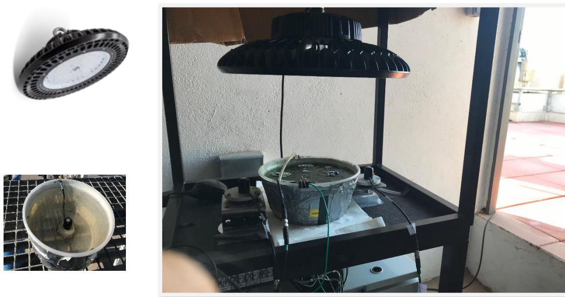
Figura 2-3 : Imagen del dispositivo experimental de cultivo de microalga a partir de agua residual doméstica del tratamiento secundario de una EDAR ubicada en Madrid.
