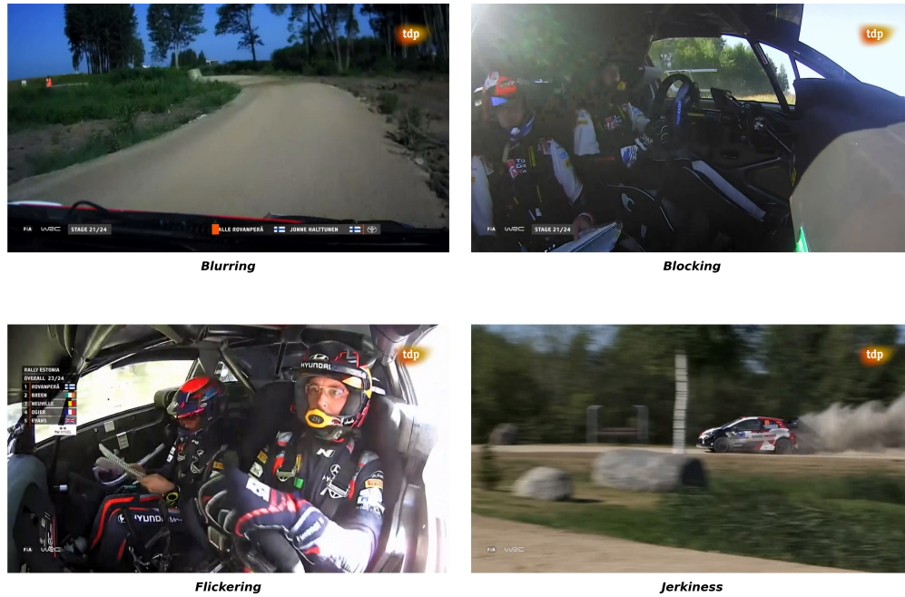
Figura 2.2: Aspecto visual de las distorsiones de blurring , blocking , flickering y jerkiness en un contenido emitido por la TDT.
