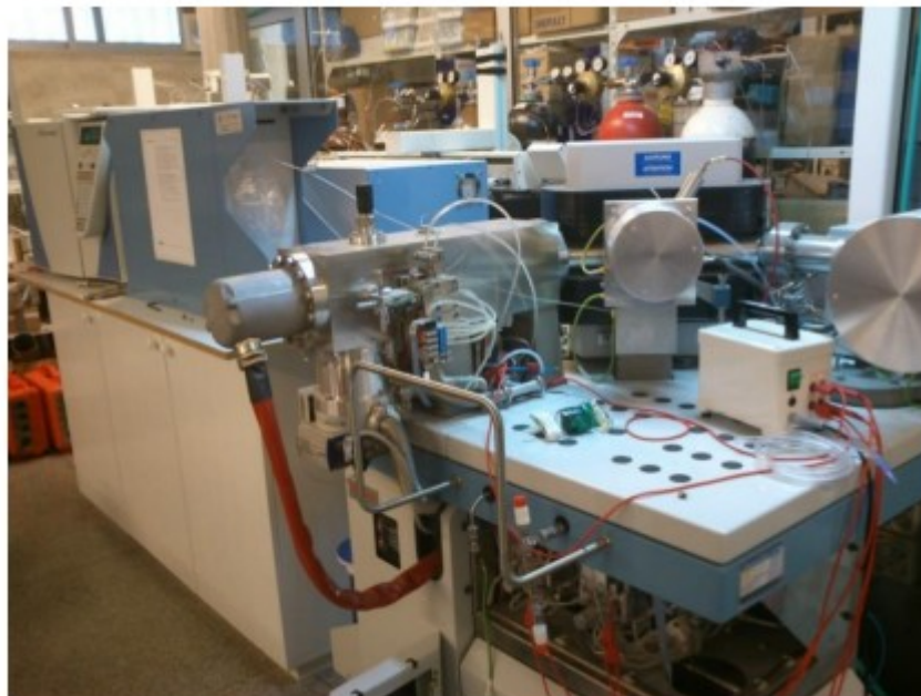
Figura 33. Análisis de muestras de gas del suelo por espectrometría de masas de relaciones isotópicas (IRMS).
