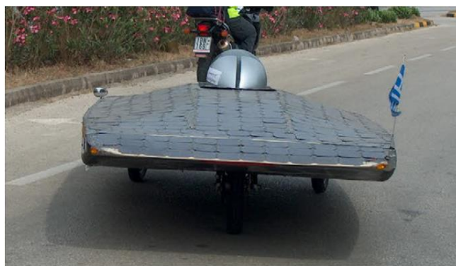
Figura 23. Coche solar HERMES construido para Phaethon 3 2004.
