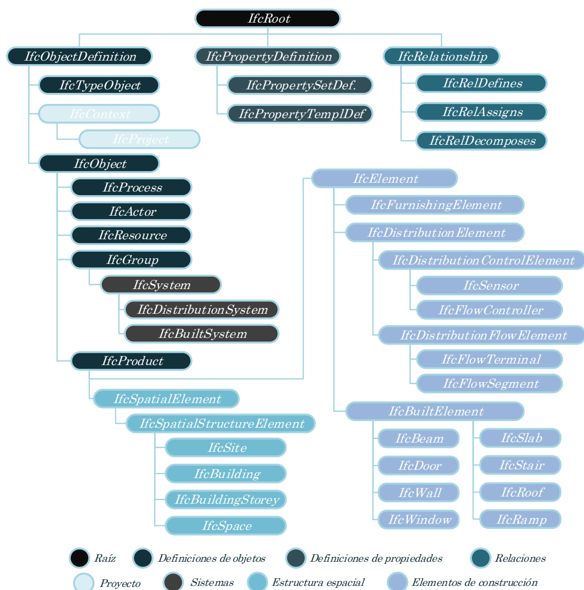
Figura 3.1.6. Definiciones principales del esquema IFC 4.3
