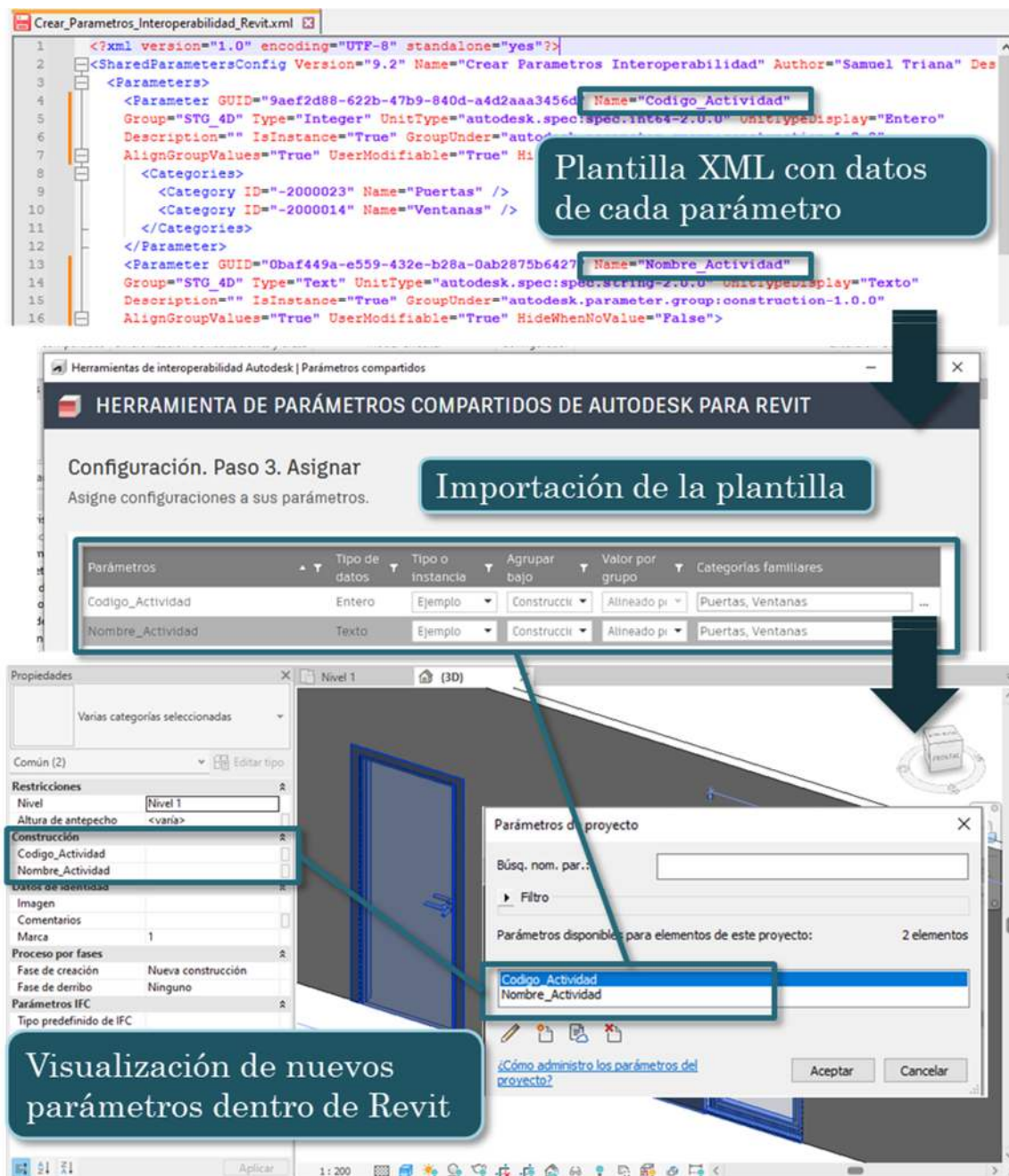
Figura 3.5.16. Creación de parámetros en Revit con XML
