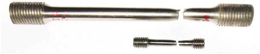
Figura 2.3.3: Probetas cilíndricas ensayadas a tracción para la caracterización del acero de las barras
