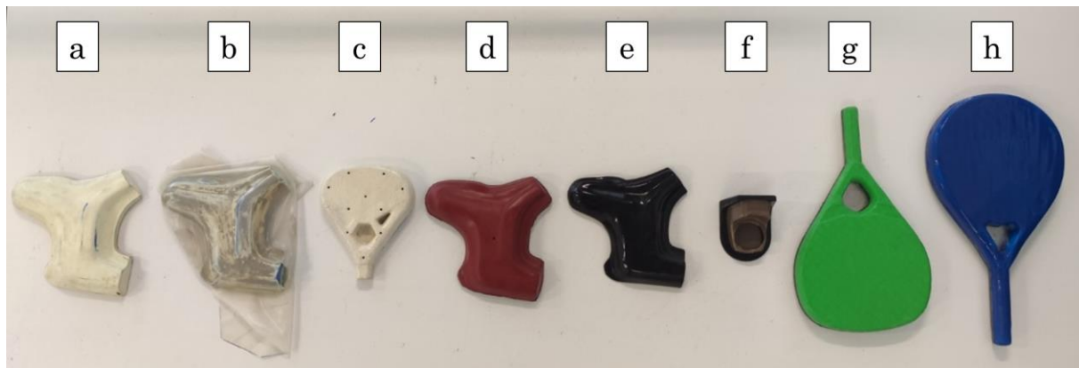
Fig. 2.11. Diferentes soluciones conceptuales para el diseño del molde rígido probadas por AEON-T. (a) PLA de impresión 3D con recubrimiento de resina de poliéster, (b) PLA de impresión 3d con recubrimiento de silicona monocomponente termoformada, (c) resina epoxi con carga de marmolina, (d) silicona de colada de shore 60, (e) aluminio mecanizado con recubrimiento silicónico a alta temperatura, (f) PLA de impresión 3D con recubrimiento de teflón adhesivo, (g) PLA de impresión 3D con recubrimiento de silicona monocomponente y (h) PLA de impresión 3D con recubrimiento de silicona bicomponente.
