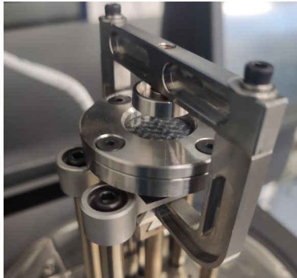
Fig. 3.5. Montaje del utillaje en el equipo DMA Q800 de TA Instruments con una muestra de preimpregnado colocada justo antes del inicio del ensayo.
