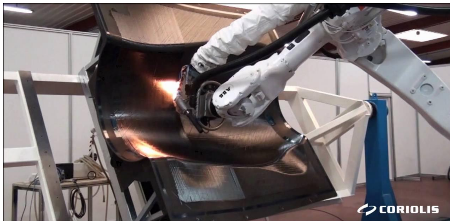
Fig. 2.9. Sistema AFP de material preimpregnado desarrollado por Coriolis [55].
