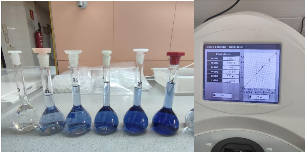
Figura 8. Curva patrón para la determinación de fósforo.
