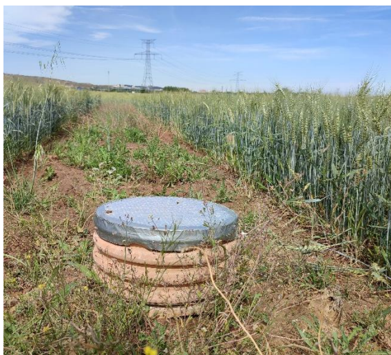
Figura 4. Cámara estática opaca manual.
