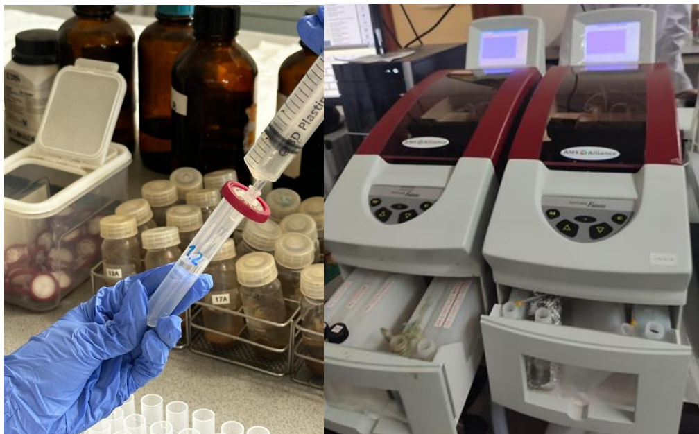
Figura 6. Procedimiento para la extracción y determinación mediante SFA de NH_4^+ y NO_3^- en suelos.
