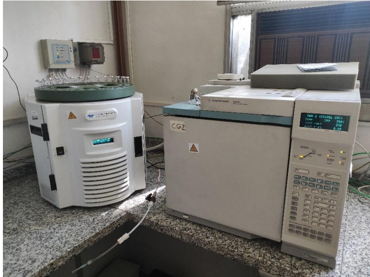
Figura 5. Cromatógrafo de gases (HP 6890, Agilent) y muestreador automático (HT3, Teledyne Tekmar).
