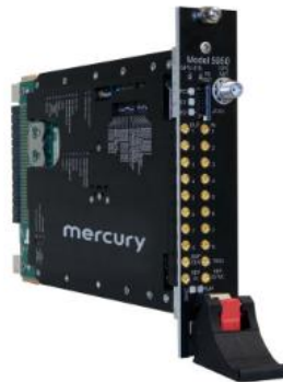
Figura 4: Sistema de preprocesado Pentek/Mercury Quartz 5950
