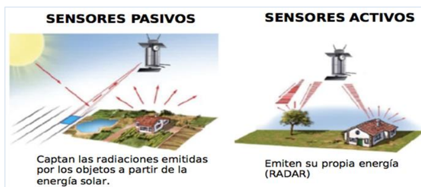
Figura 11. Descripción funcionamiento Radar Pasivo vs Activo [27].
