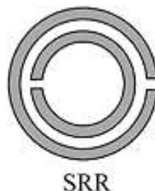
Figura 10. Topologías típicas de un SRR (Split-Ring Resonator). Imagen extraída [8].
