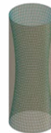
Fig. 57: Resultado del código para la adaptación de la teselación en un cilindro a un hiperboloide
