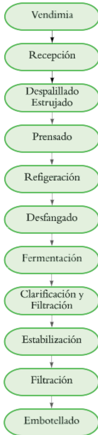
Figura 2. Diagrama del proceso productivo
