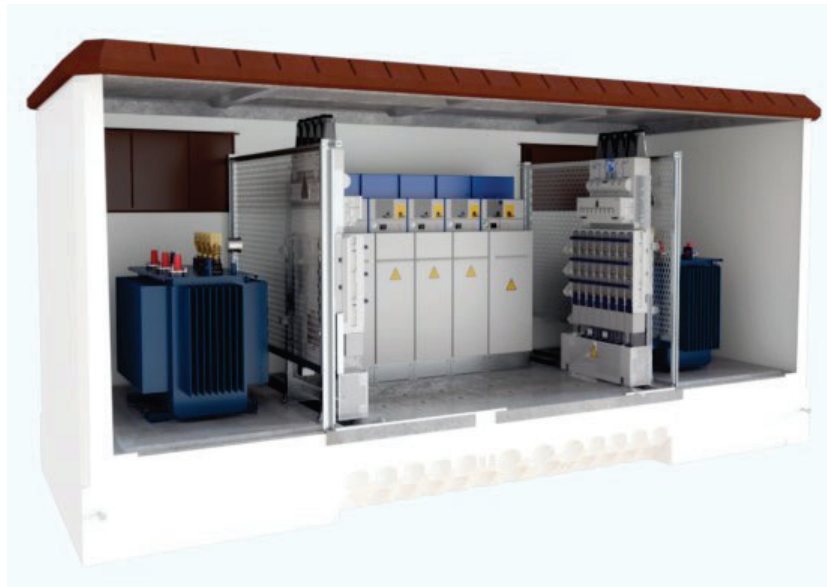
Ilustración 4. Centro de transformación
