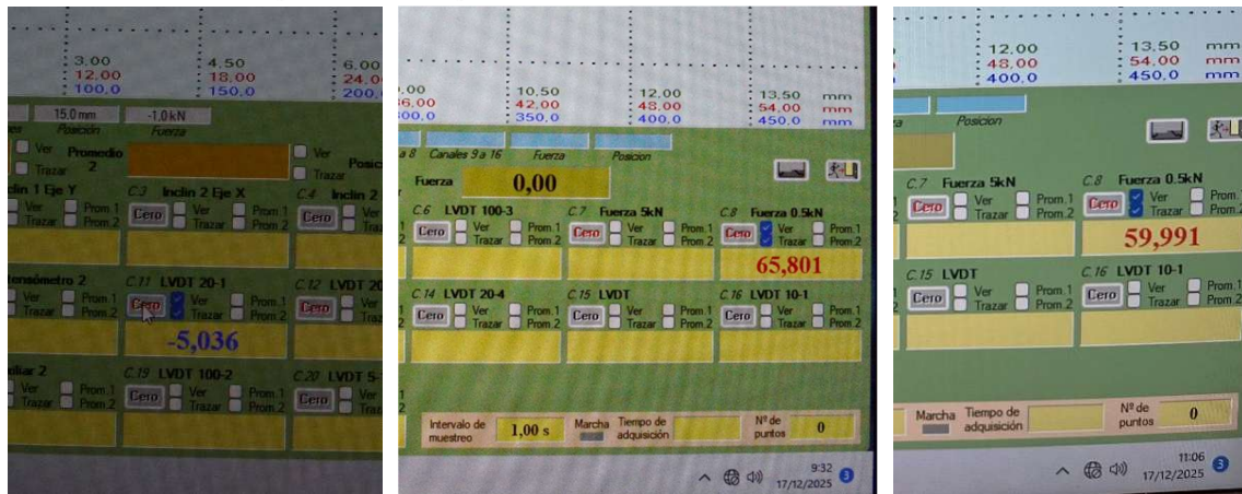
Fig. 70. Mediciones durante la prueba de carga 1. Izq.: Medición del LVDT al final del ensayo; centro: fuerza registrada al inicio del fotografiado; dcha.: fuerza registrada al final del fotografiado.
