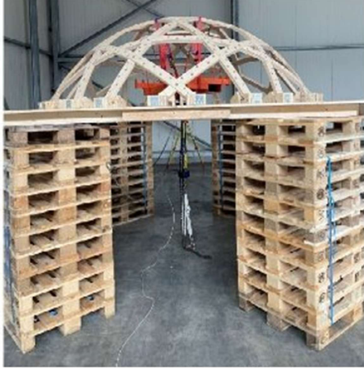
Fig. 21. Prueba de carga. Spherical cap gridshell
