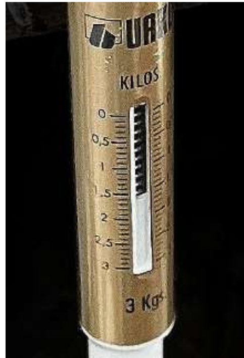
Fig. 64. Prueba de carga del dispositivo nodal. Izq.: Imagen general del ensayo; dcha.: detalle del dinamómetro con la carga máxima alcanzada durante el ensayo.
