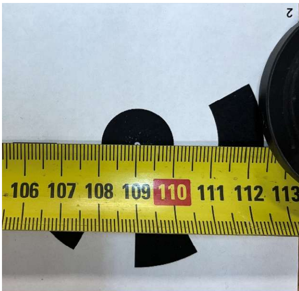
Fig. 73. Toma de distancias entre las dianas codificadas del tablero.
