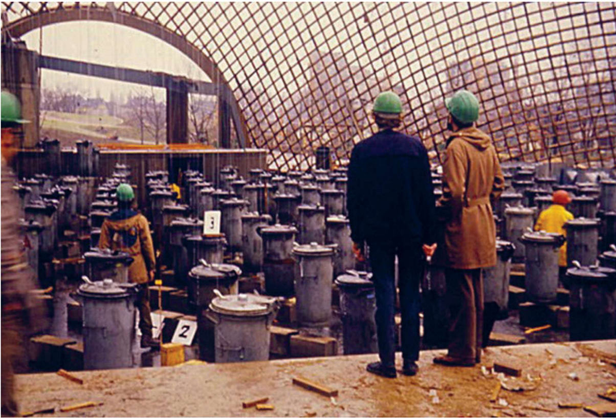
Fig. 01. Vista interior de la Multihalle durante la prueba de carga, Mannheim. Frei Otto, 1975.
