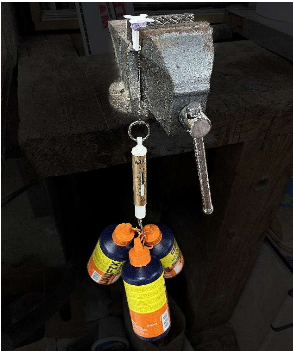
Fig. 64. Prueba de carga del dispositivo nodal. Izq.: Imagen general del ensayo; dcha.: detalle del dinamómetro con la carga máxima alcanzada durante el ensayo.
