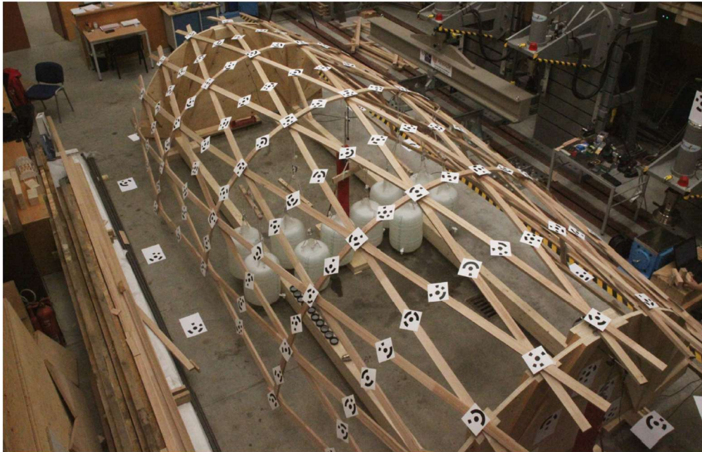
Fig. 17. Prueba de carga. Triaxial elastic gridshell
