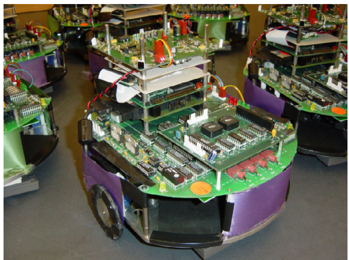
Imagen 15: Mooreboot, la plataforma que implementa el sensor R&B de I. Kelly y A. Martinoli [14]
