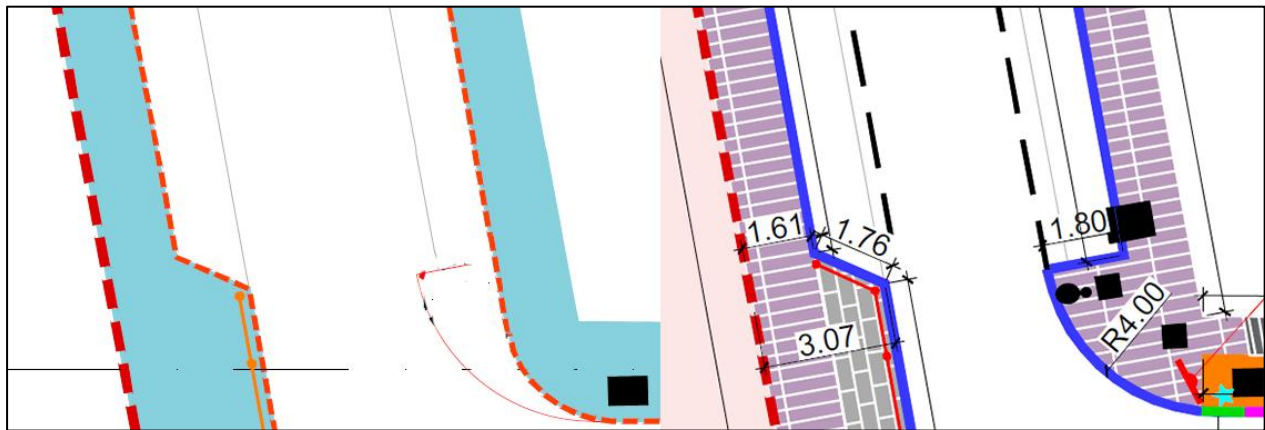
Figura 40. Estado existente (izquierda) y proyectado (derecha) de orejetas peatonales y barandilla tipo Río MU-72 en calle de Esparta. Fuente: Grupo SEG y Serynco Ingenieros, S.A., noviembre 2022.
