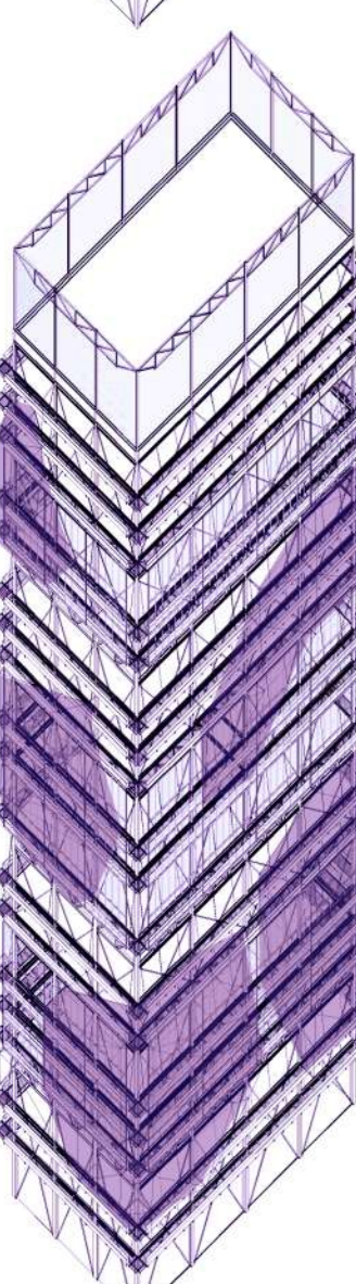
Estructura de ménsulas y cables de acero inoxidable para el soporte de las mallas vegetales
