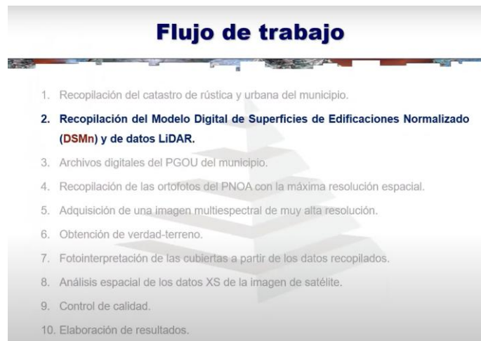
Ilustración 2. Flujo de trabajo de detección de amianto en Alcobendas. Fuente: Webinar ¿Cómo realizar el censo de Amianto de tu Ayuntamiento? (Youtube)
