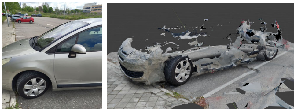
Figura 7: Reconstrucción fallida de un coche por exceso de reflexión
