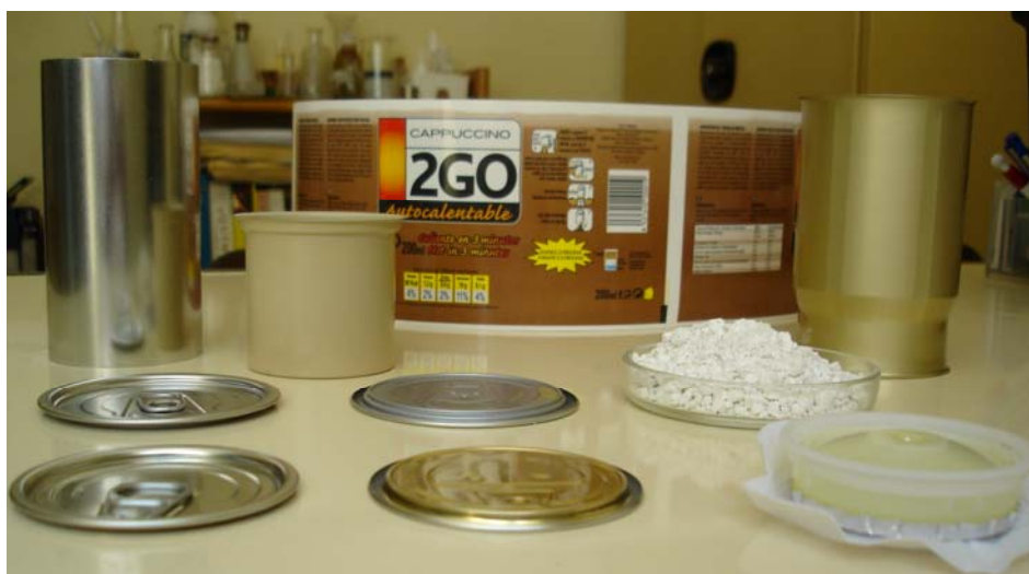
Figura 3: Conjunto de piezas y reactivos que forman el envase de la bebida autocalentable analizada.
