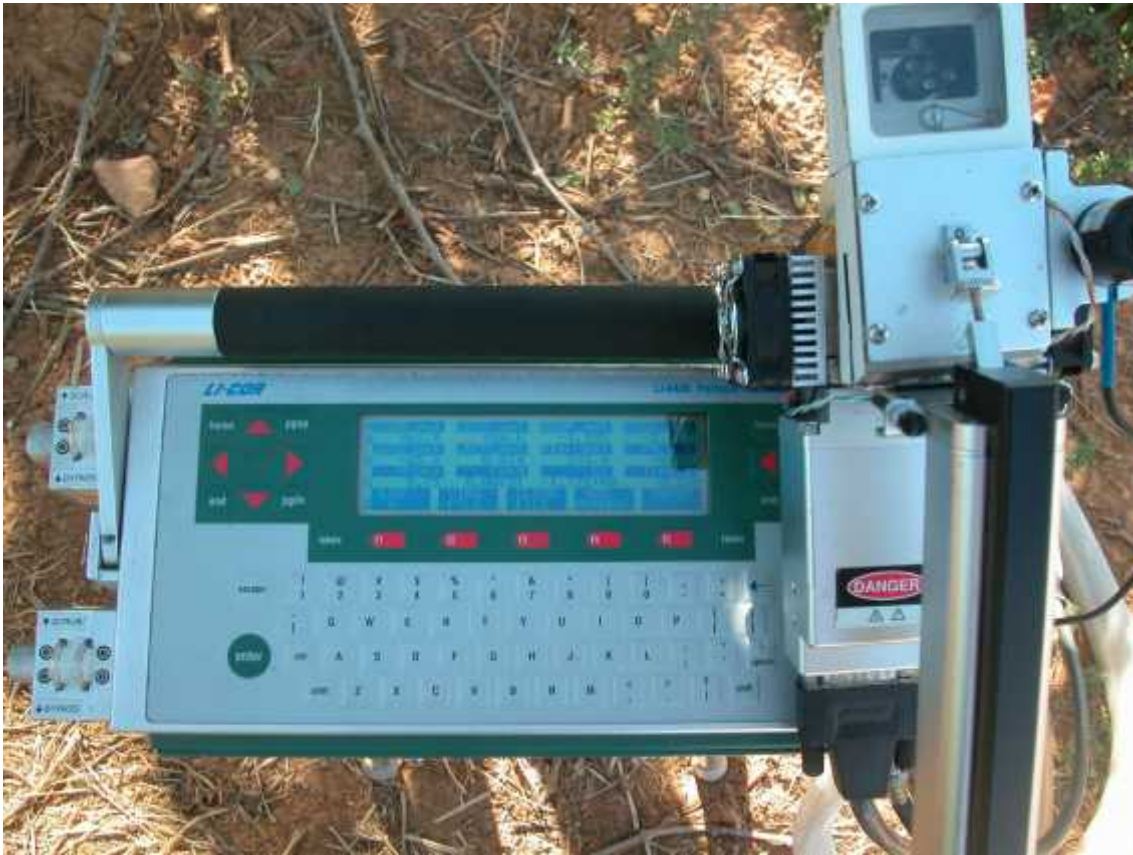
Imagen V.2: IRGA. Sistema abierto de medida de intercambio de gases por infrarrojos (Li-6400, Li-Cor Inc., Lincoln, Nebraska, USA.)
