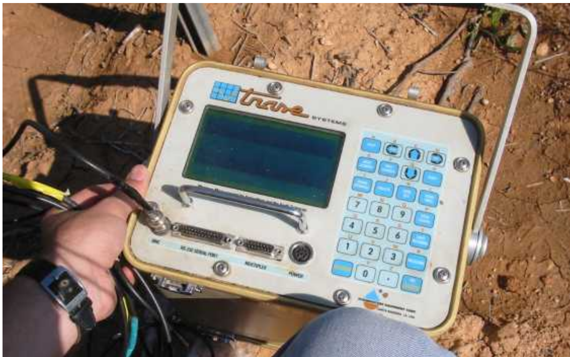
Imagen IV.3: TDR (Time-domain Reflectometry), equipo portátil Modelo No. 6050X1 del sistema Trase, Soil moisture Equipment Corp. (Santa Bárbara, California).
