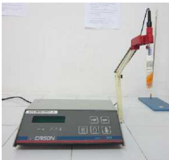
Imagen VII.2: pHímetro (micropH 2001, CRISON, Barcelona, España) del laboratorio del departamento de Producción Vegetal: Fitotecnia de la UPM.
