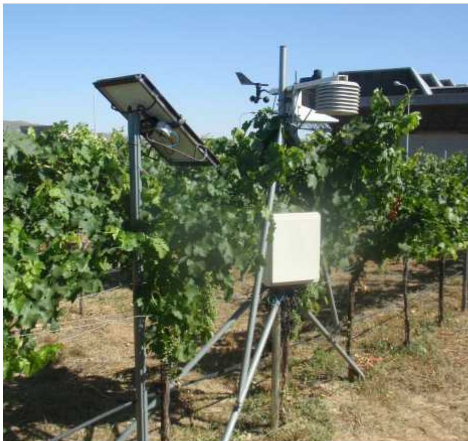
Imagen III.3: Estación meteorológica GroweatherTM System (Davis), situada en la parcela experimental.
