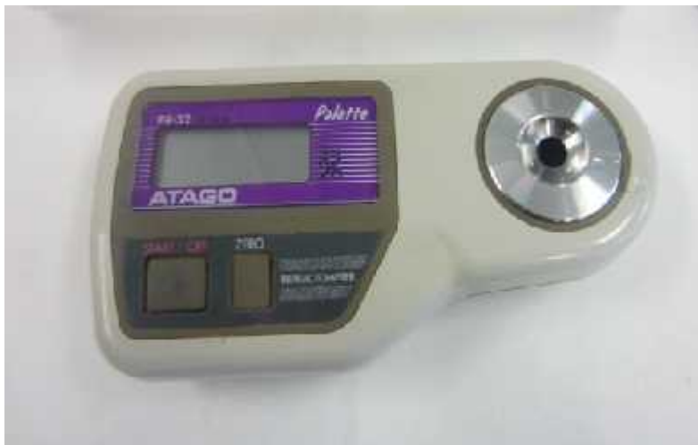
Imagen VII.1: Refractómetro (PALETTE WM-7, ATAGO Inc., Kirkland, WA, USA) del laboratorio del departamento de Producción Vegetal: Fitotecnia de la UPM.
