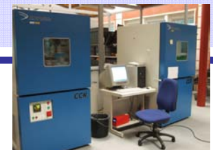
Los test de tolerancia al frío se realizaron en una cámara de simulación de heladas Dycometal Serie CCK/CM.
