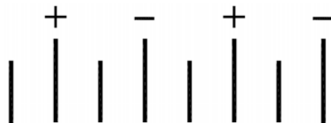
Figura 4. Configuración de electrodos mediante dos fuentes separadas
