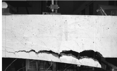
a) End debond in beam E1a
