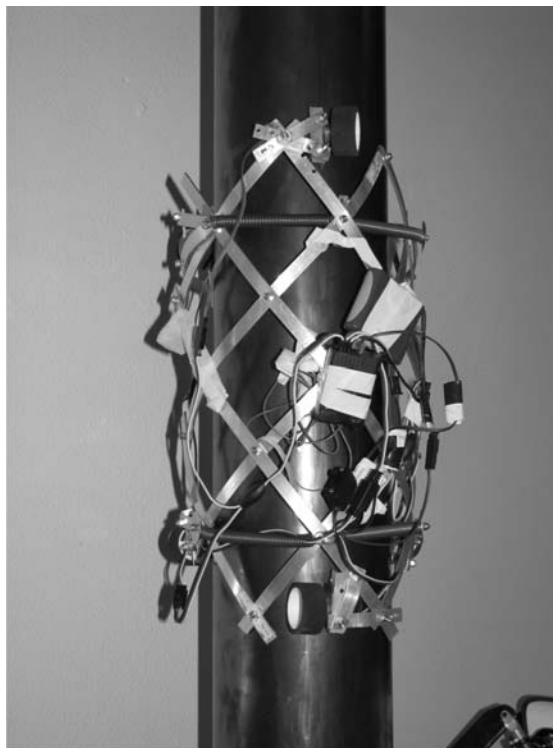
Figura 11. Robot en tuberías de operación vertical (RETOV).
