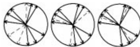
Figura 5.8 Proceso de aprendizaje en 2D a) Inicio b) Ordenamiento c) Convergencia
