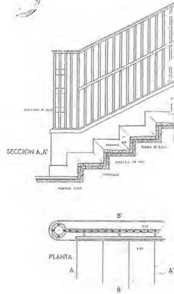
ESCALERA PRINCIPAL (DETALLE) ESCALA 1:10
