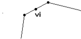
Figura 2.8: El segmento a la izquierda de v_i se puede prolongar por la derecha, si hay más de un punto alineado con él
