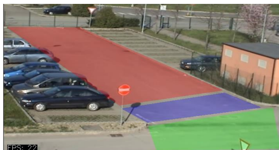
Figura 56. Las tres zonas para el control de entrada/salida y de conteo de vehículos Fuente [43].
