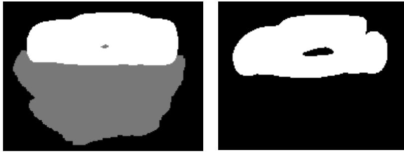
Figura 35. A la izquierda, componente segmentada con sombras detectadas en gris. A la derecha, componente segmentada pero con sombras eliminadas. Fuente [39].
