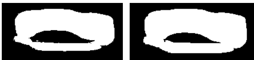
Figura 36. A la izquierda, componente segmentada sin aplicar dilatación morfológica. A la derecha, la misma componente pero dilatada morfológicamente
